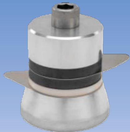
Transdutores Piezoelétricos Cerâmicos Patenteados
